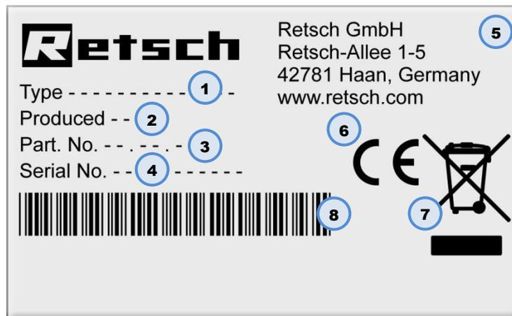
Abb. 1: Typenschild Beschriftung
